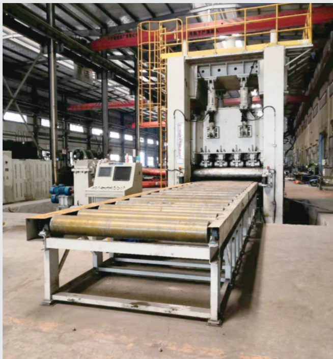
长沙瑞捷EZW43T-25×2000 1200MPa 11辊高强度钢校平机
