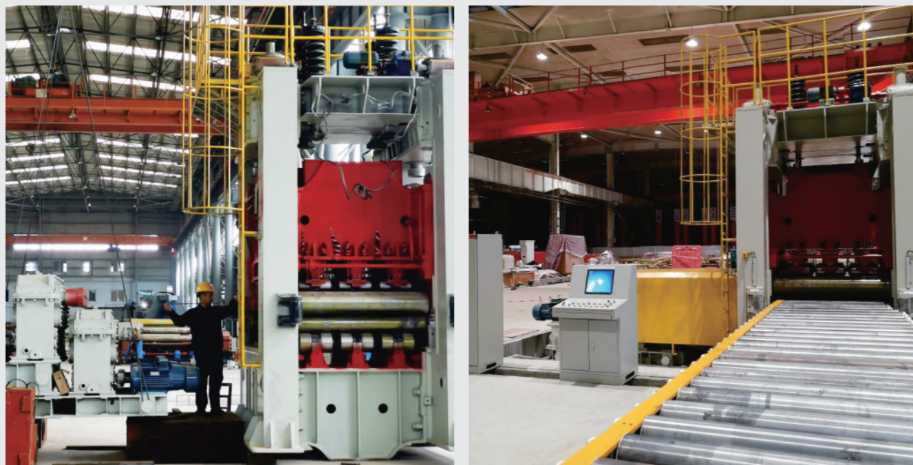
EZW43-20×1500 785MPa 11辊高强钢校平机 三一重工
