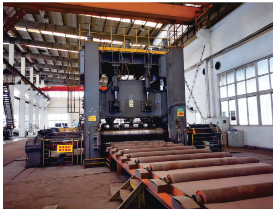
中船725所EZW43T-40×3000九辊金属复合板材校平机 360MPa 九辊高强度钢校平机
