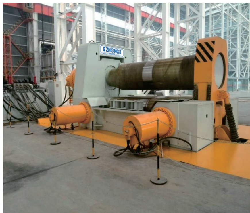
EZW11S-120×3200数控可变中心距三辊卷板机
