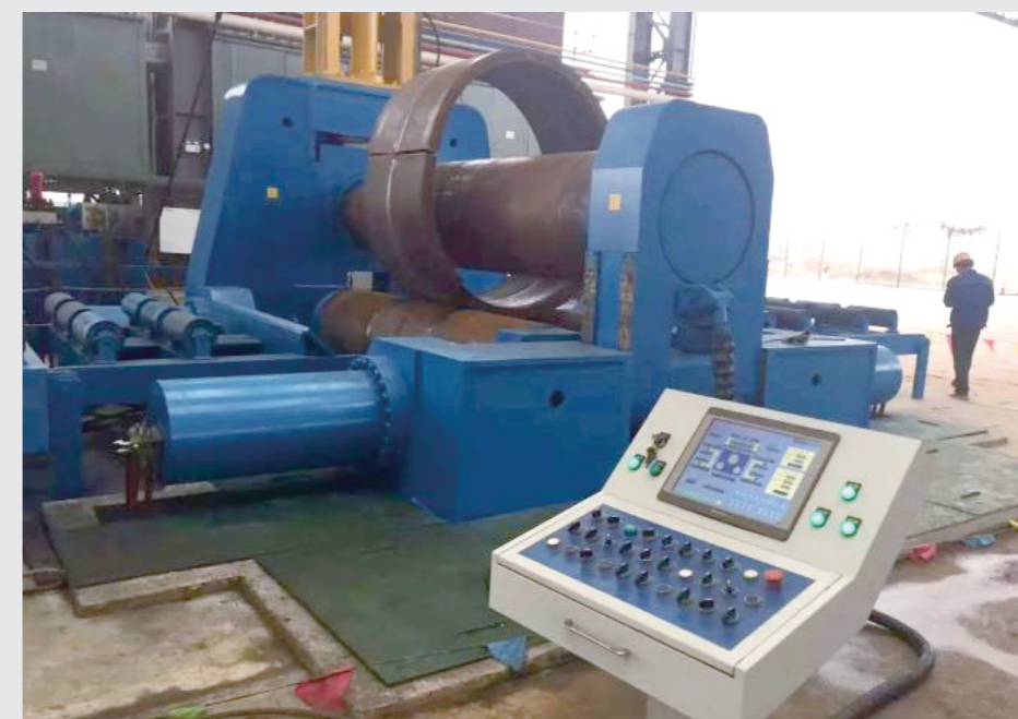
EZW11S-150×3200数控可变中心距三辊卷板机
