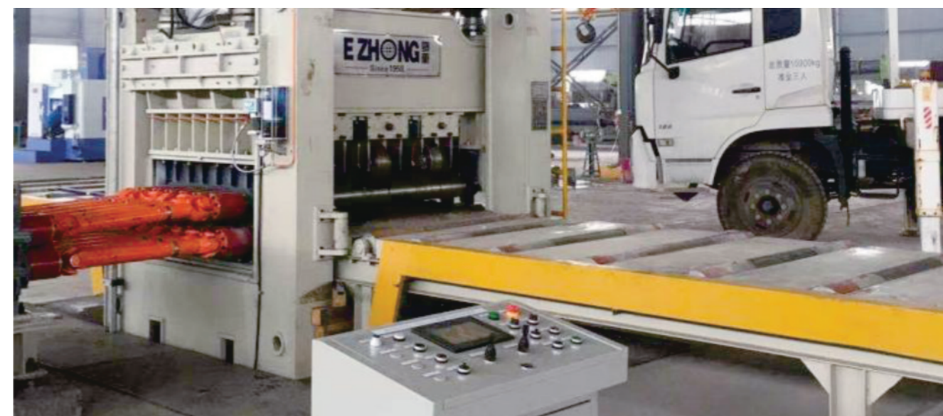
为中联重科设计制造的EZW43-8×1500 高强钢800MPa 13辊校平机
